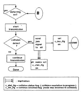
Fig. 2. METHOD\_X (Ethernet Part)
